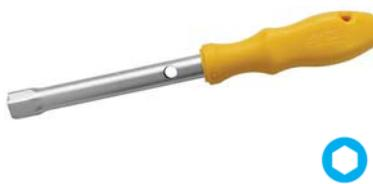
Tipo professionale in acciaio in CROMO-VANADIO 31CrV3. Esecuzione cromata opaca. Bocche esagonali. Impugnatura ergonomica in materiale plastico QUATROLIT®, con foro di aggancio. Da mm 8 con foro per leva Art. 900 A da 6 e 8.
